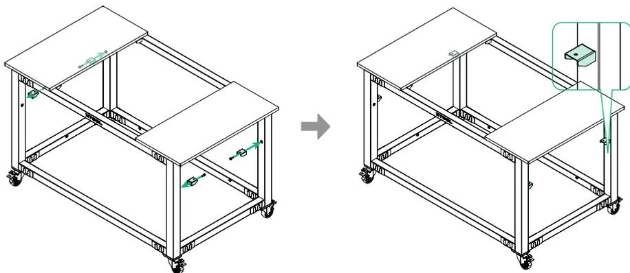
(2) Instale o painel (dimensões recomendadas: 590 mm x 1140 mm x 12 mm). O resultado final da instalação é apresentado abaixo.
