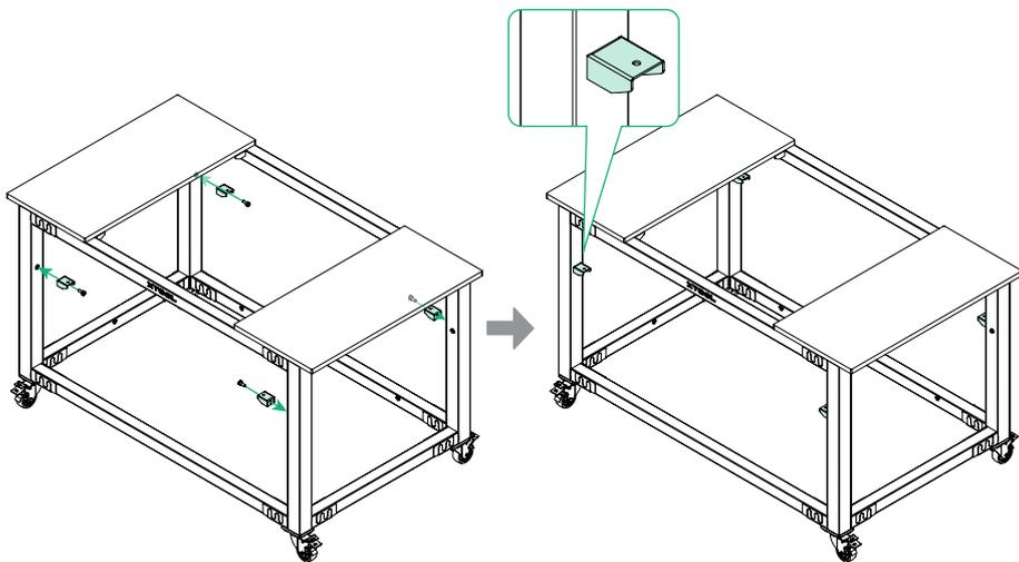
(2) Instale o painel (dimensões recomendadas: 690 mm x 1040 mm x 12 mm). O resultado final da instalação é apresentado abaixo.
