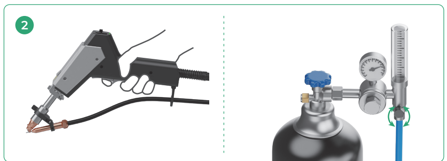
(2) 按住握持感測按鈕與扳機，使氣路導通，同時調整氣體流量至 15 L/min ~ 30 L/min。
