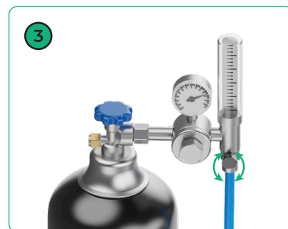
(3) Stel de gasstroom in op 15 L/min - 30 L/min
