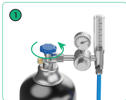
(1) Otworzyć zawór butli gazowej
