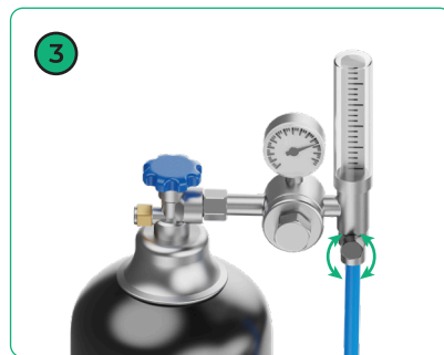
(3) Ustaw natężenie przepływu gazu na 15 l/min - 30 l/min
