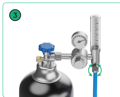
(3) Ajuste el caudal de gas a 15 L/min - 30 L/min
