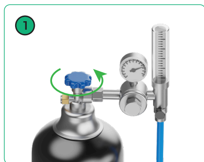
(1) Öffnen Sie das Gasflaschenventil
