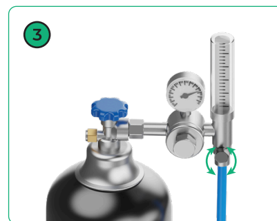
(3) Stellen Sie den Gasdurchfluss auf 15–30 L/min ein.
