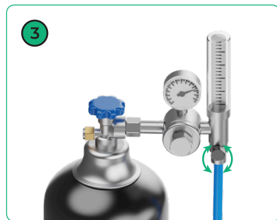
(3) 调节气流量至 15 L/min ~ 30 L/min
