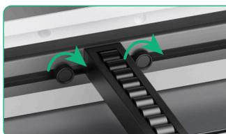
Déplacez le rail de convoyeur à la position appropriée en fonction de la largeur du matériau à traiter et serrez les vis dans le sens des aiguilles d'une montre.
