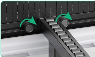
Bewegen Sie die Förderschiene je nach Materialbreite an die passende Position und ziehen Sie die Schrauben im Uhrzeigersinn fest.
