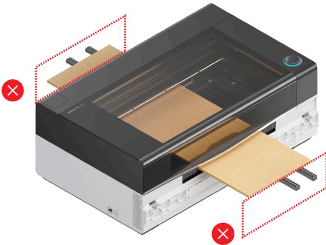
■ Um sicherzustellen, dass das Material fest fixiert ist und gleichmäßig zugeführt wird, achten Sie bitte darauf, dass das Material an Vorder- und Rückseite jeweils gleich weit übersteht.
